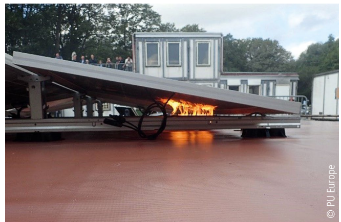
Abb. 5 Versuchsbeginn – Brenner unter den PV-Modulen entzündet
