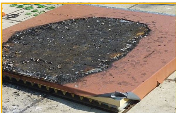
Abb. 7: PU-Dach (links) und MW-Dach (rechts) – verbrannte Fläche nach Entfernen der PV-Elemente
