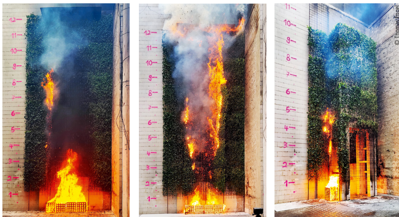
Abb. 9: links: flächiger Versuch mit vitaler Begrünung (V1); Mitte: flächiger Versuch mit getrockneter (toter) Begrünung (V2); rechts: Balkonversuch mit Brandeinwirkung in der Ecke mit vitaler Begrünung (V4)
