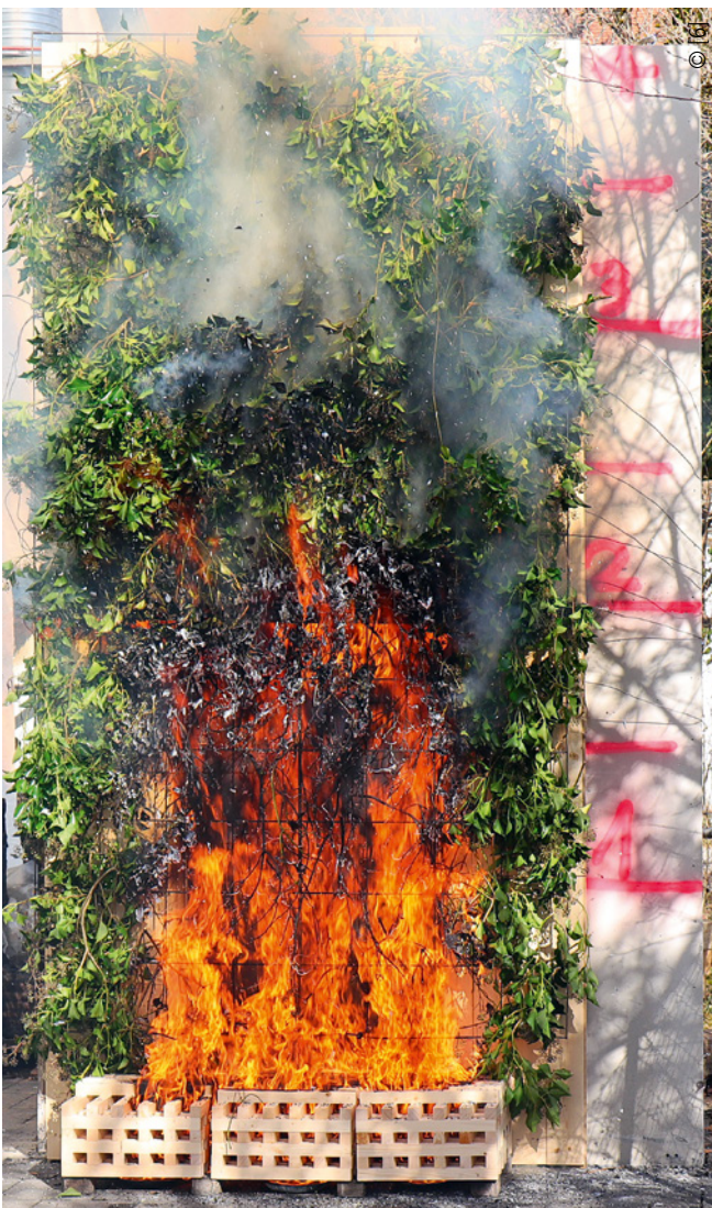
Abb. 6: Fotodokumentation des Brandversuchs Test 3 mit Holz- und Grünfassade zur dritten Prüfminute
