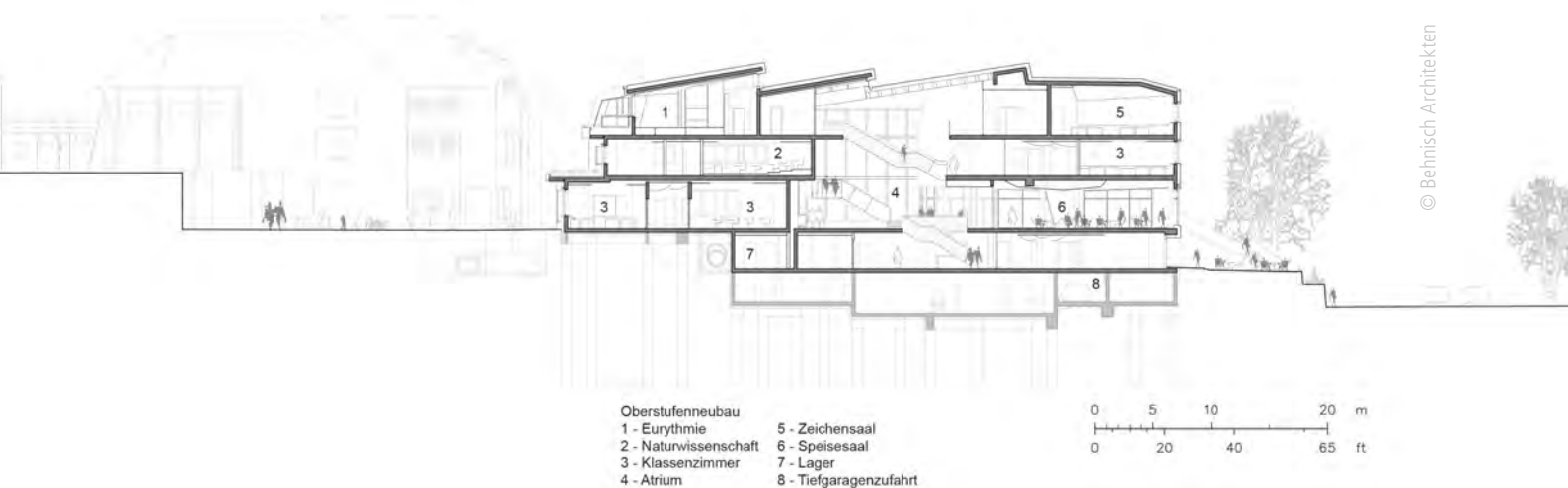
Abb. 3: Das große Atrium in der Mitte des Gebäudes ist wichtiger Baustein der Lüftungsanlage
